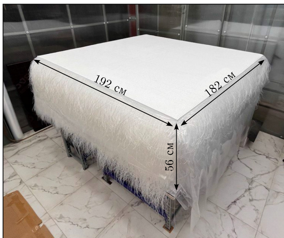
Рис. 3. Детектор SuperFGD, собранный с использованием калиброванной лески в ИЯИ РАН
