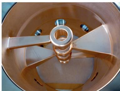
Рис. 5. Трубка дрейфа в ходе изготовления резонатора DTL
