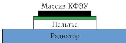
Рис. 3. Схема системы термостабилизации счетчика АШИФ
