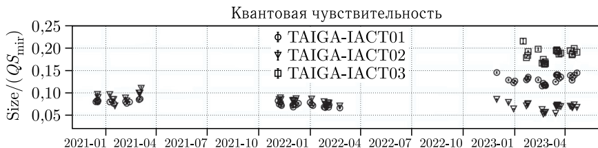
Рис. 4. Изменение интегральной «квантовой чувствительности» трех телескопов установки TAIGA-IACF в период 2020–2023 гг. Каждая точка характеризует ошибку среднего значения эффективности регистрации черенковских фотонов телескопом за один сеанс наблюдений, содержащий не менее 250 совместных событий TAIGA-IACF и TAIGA-HiSCORE
