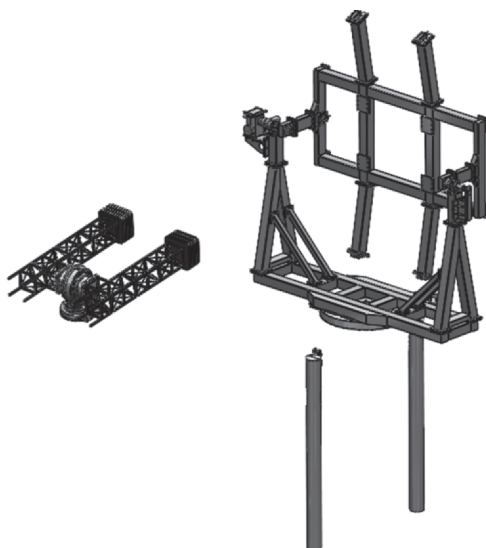
Рис. 3. Внешний вид сборок, обеспечивающих идентичное функционирование по азимуту и углу места: слева — опорно-поворотное устройство DAD6-Z0-LM с системой противовесов; справа — поворотная платформа, люлька с узлами механизации и трубами системы противовесов, устанавливаемых в фундамент телескопа. Сохранены относительные размеры сборок
