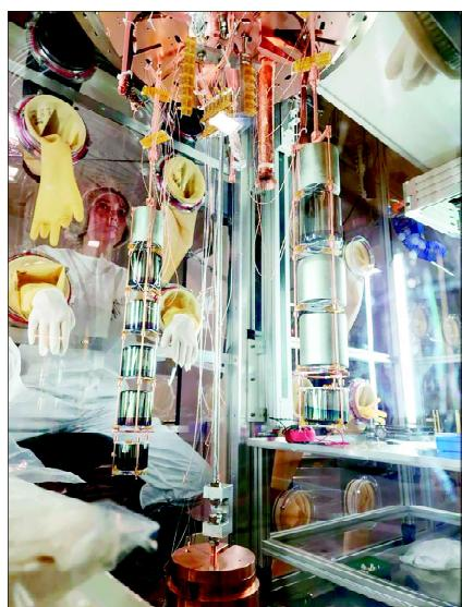
при нашем непосредственном участии была успешно осуществлена финальная сборка 60 кг германиевых детекторов в 4 гирлянды, на которые были надеты привезенные из Мюнхена нейлоновые кожухи, и произведен монтаж системы активного аргонового вето. Теперь настало время набора первых экспериментальных данных, а затем, осенью 2022 года, мы планируем вернуться в Гран-Сассо, чтобы завершить инсталляцию всех имеющихся детекторов и запустить эксперимент LEGEND в полном масштабе.
