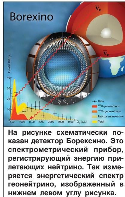
На рисунке схематически показан детектор Борексино. Это спектрометрический прибор, регистрирующий энергию прилетающих нейтрино. Так измеряется энергетический спектр геонейтрино, изображенный в нижнем левом углу рисунка.
