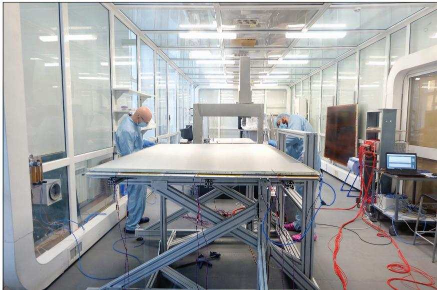
ров НМК ATLAS. Площадь поверхности камер примерно три квадратных метра. Всего должно быть произведено 64 (+4) двухсторонних считающих панели и собрано 32 (+2) модуля, или, по-другому, квадруплета. Квадруплет состоит из двух двухсторонних считающих панелей и трех дрейфовых. После изготовления должно состояться тестирование и отдельных панелей, и модулей на точность геометрических характеристи-
