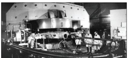
**9.** 60 лет назад в Лаборатории ядерных реакций ОИЯИ был создан циклотрон У-300 – уникальный по тому времени ускоритель тяжелых ионов для проведения ядерно-физических, химических и прикладных исследований. Циклотрон был спроектирован в соответствии с концепцией, предложенной академиком Г. Н. Флеровым. 9 сентября 1960 года на циклотроне был получен первый пучок ускоренных ионов азота.
