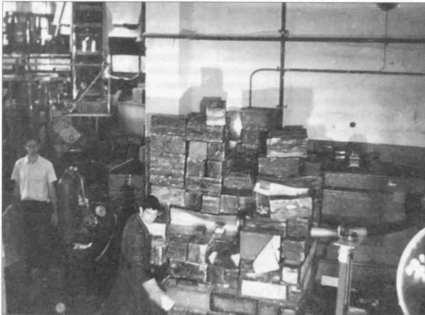
Детекторная часть установки, расположенная в экспериментальном зале реактора ИБР-1, на которой впервые наблюдалось длительное хранение нейтронов в сосуде – медной трубе (изогнутая часть видна на снимке справа). Монтаж ведут лаборант С. И. Неговелов (в центре) и аспирант Института химической физики Ю. Н. Покотиловский (слева). Август 1968 года.
