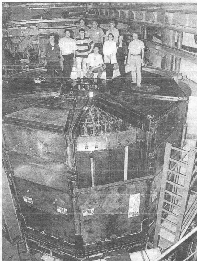
Детектор перед закрытием последней секции железной защиты. Внутри видно ядро детектора NEMO; вверху – члены коллаборации NEMO.
