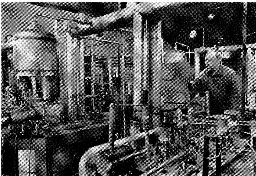
Здесь создан крупнейший в Советском Союзе гелиевый криогенный комплекс для охлаждения сверхпроводящих магнитов нуклотрона при температуре 4,5 К.
