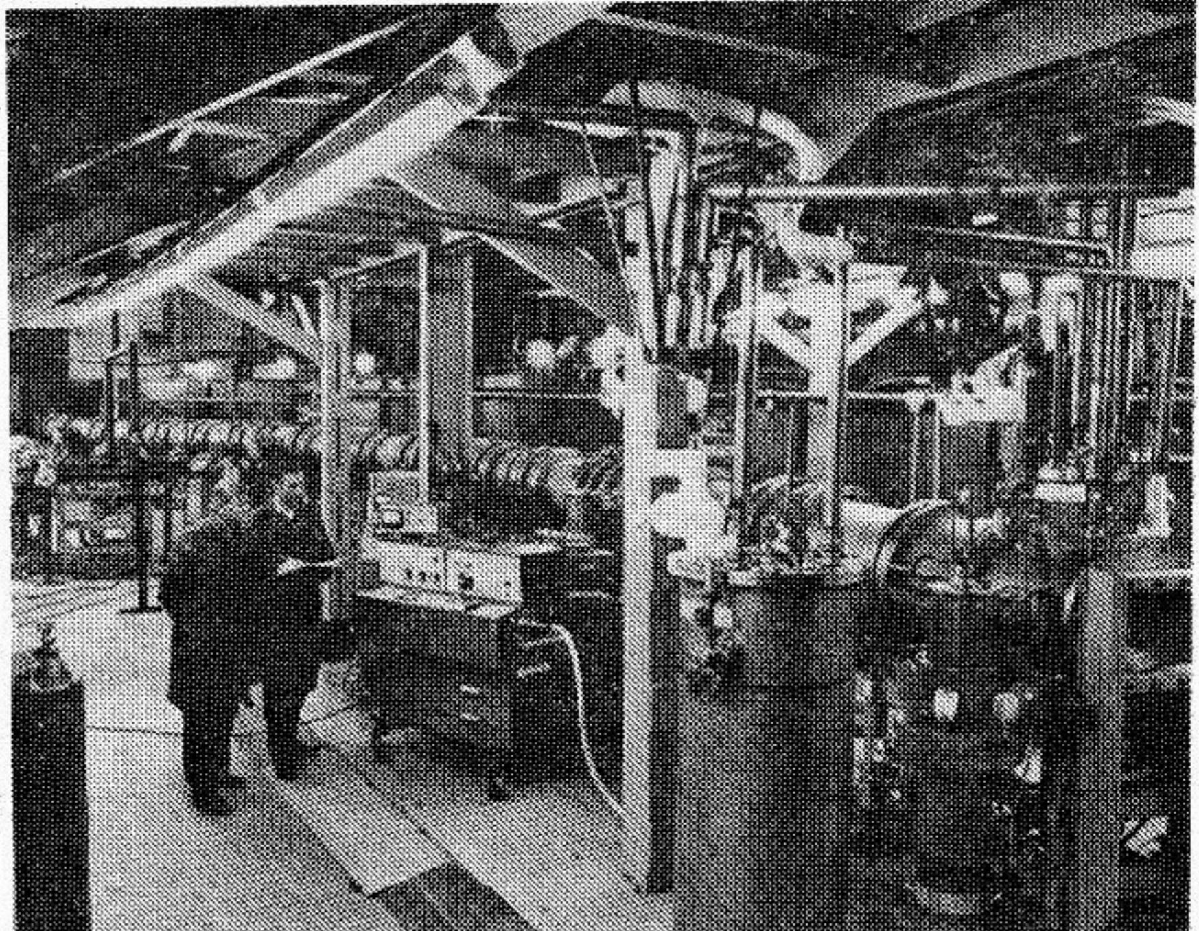
В Лаборатории высоких энергий продолжаются работы на стенде № 9, где проходят комплексные криогенные и электротехнические испытания октанта магнитной системы нуклонома.
