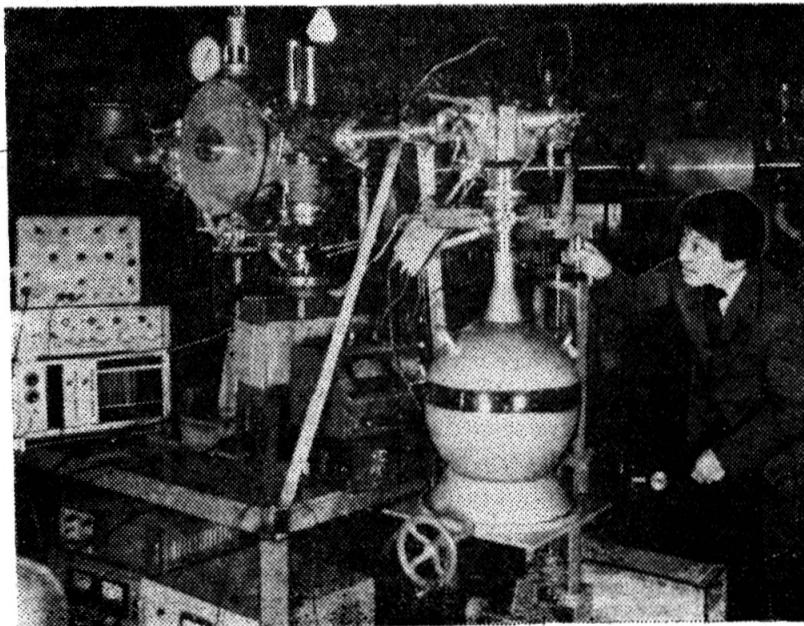
В Лаборатории нейтронной физики успешно развиваются прикладные исследования. На снимке: установка по определению элементного состава вещества методом измерения рентгеновских лучей, возбуждаемых при облучении его пучком протонов от электростатического генератора типа Ван-де-Графа. Научный сотрудник ЛНФ А. Пурэ из Монгольской Народной Республики готовится к работе спектрометр рентгеновских лучей.
