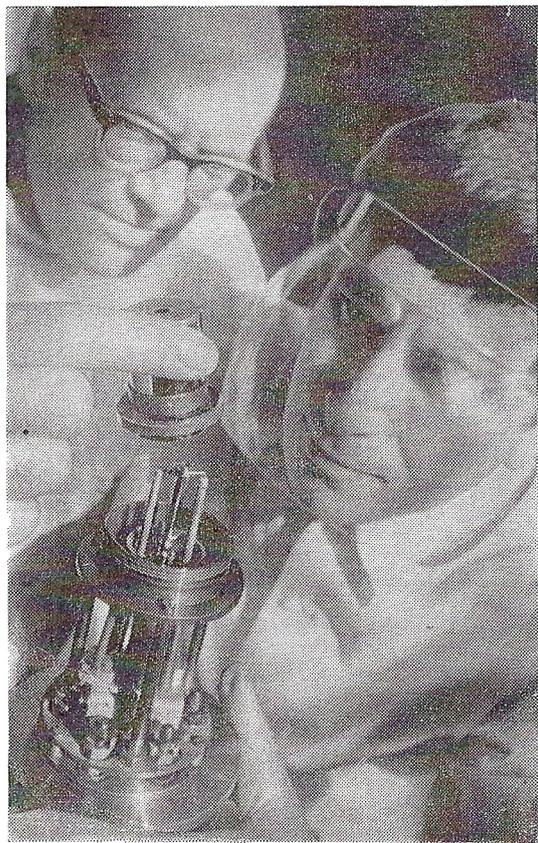
В Лаборатории ядерных проблем по программе ЯСНАПП действует сложное экспериментальное оборудование, одним из основных элементов которого является новый ионный источник, разработанный в интернациональном коллективе отдела ядерной спектроскопии и радиохимии. Этот источник признан изобретением.
